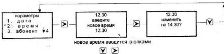
Рисунок И.4 - Структурная схема подменю ПАРАМЕТРЫ тепловычислителя (установка параметра ВРЕМЯ)
