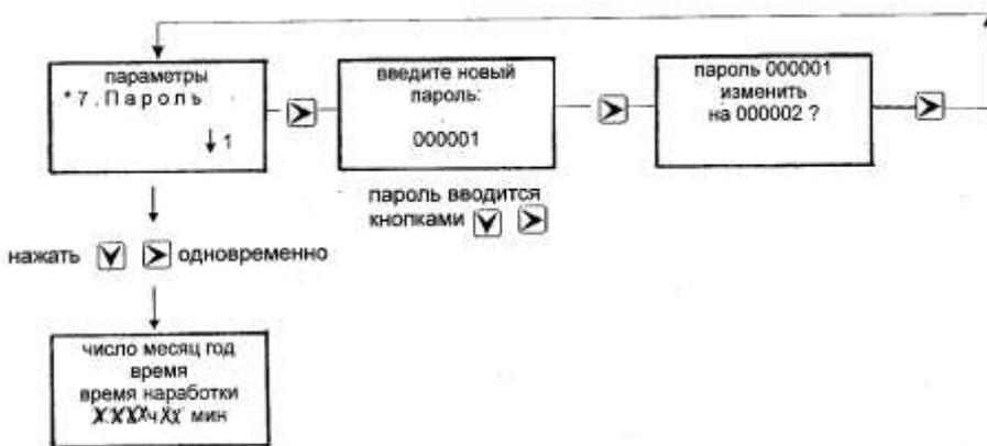
Рисунок И.9 - Структурная схема подменю ПАРАМЕТРЫ тепловычислителя ТВМ (установка, при необходимости, кода нового пароля)
