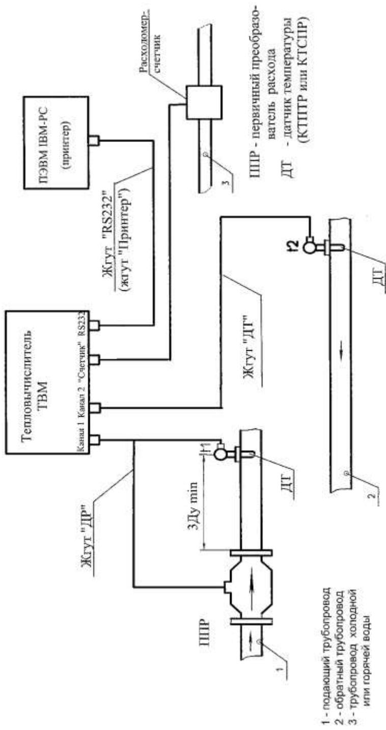
Рисунок А.2 - Вариант 2 - Учет тепловой энергии в закрытых системах теплоснабжения (ППР в подающем трубопроводе) и, по желанию потребителя, объема воды в третьем трубопроводе (холодной или горячей) воды
