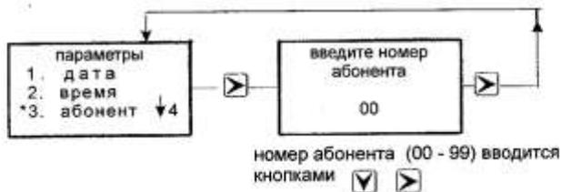
Рисунок И.5 - Структурная схема подменю ПАРАМЕТРЫ тепловычислителя (установка параметра АБОНЕНТ)
